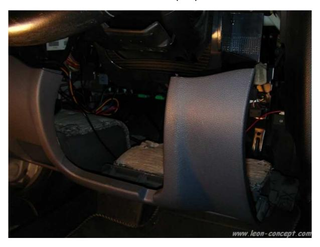
Démontage de la boite à gant, elle tient avec 9 ou 10 vis Torx et puis débrancher les câbles de la lumière de la boite à gant et du chargeur cd si vous l'avez:
