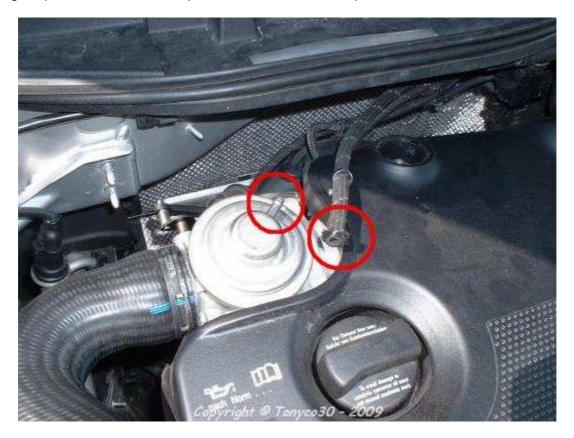
Pour boucher le tuyau, j'ai découpé une longue vis pour ne garder que la tète et le corps de 2 cm environ. Il faut aussi trouver une durite similaire à celle d'origine afin d'obstruer "l'entrée" de la vanne.
