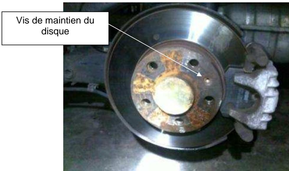
Puis, il faut démonter l'étrier. Pour cela, il faut dévisser les deux vis (allen femelle) qui le maintiennent par l'arrière :
