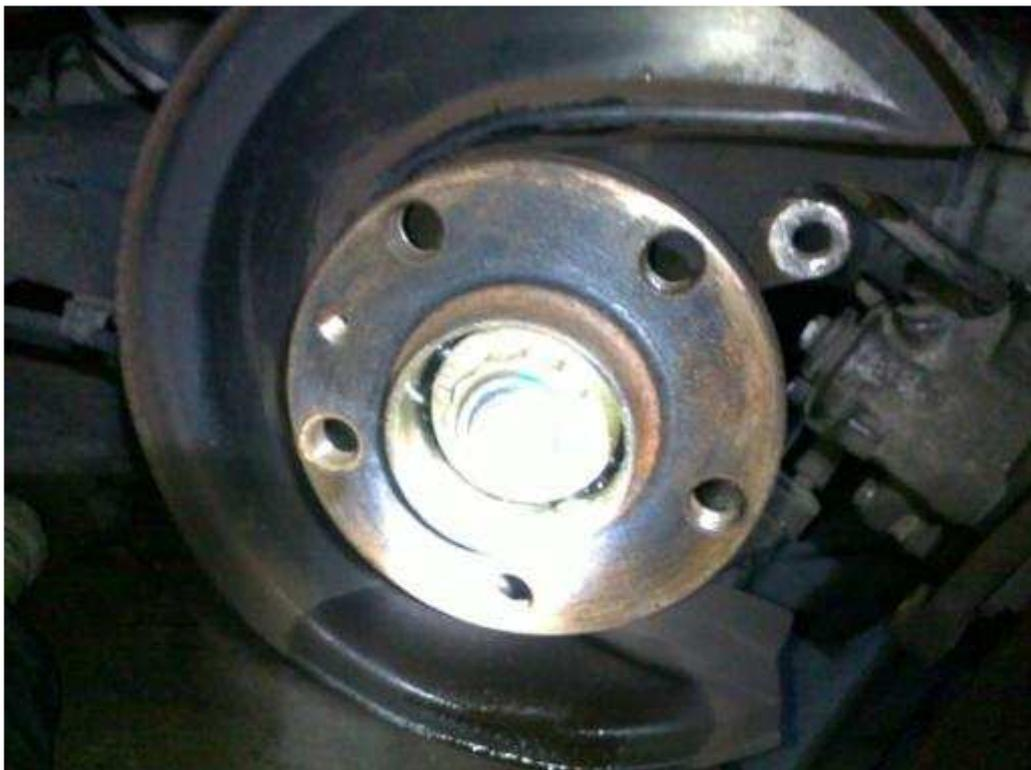
Puis on dévisse l'écrou dodécagonal. Là il va falloir forcer un peu ou utiliser un bras de levier :
