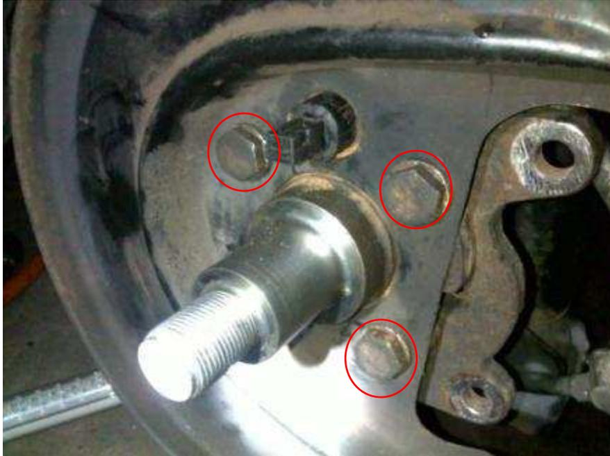
Attention au capteur ABS, il vaut mieux l'enlever lors du passage à l'étau. Les vis entourées de rouge sont serrées à un couple de 60Nm.
