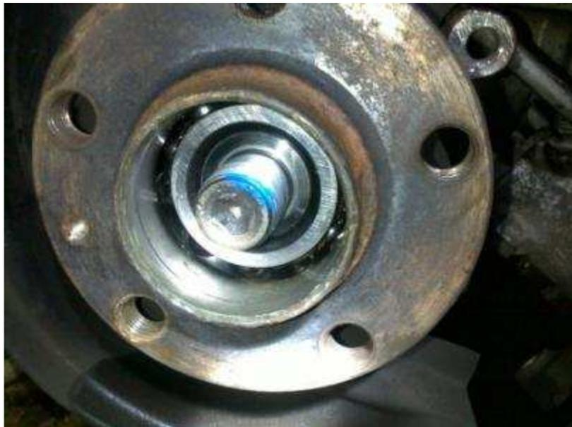
On sort maintenant la griffe qui va nous permettre d'extraire l'ensemble moyeu + roulement :
