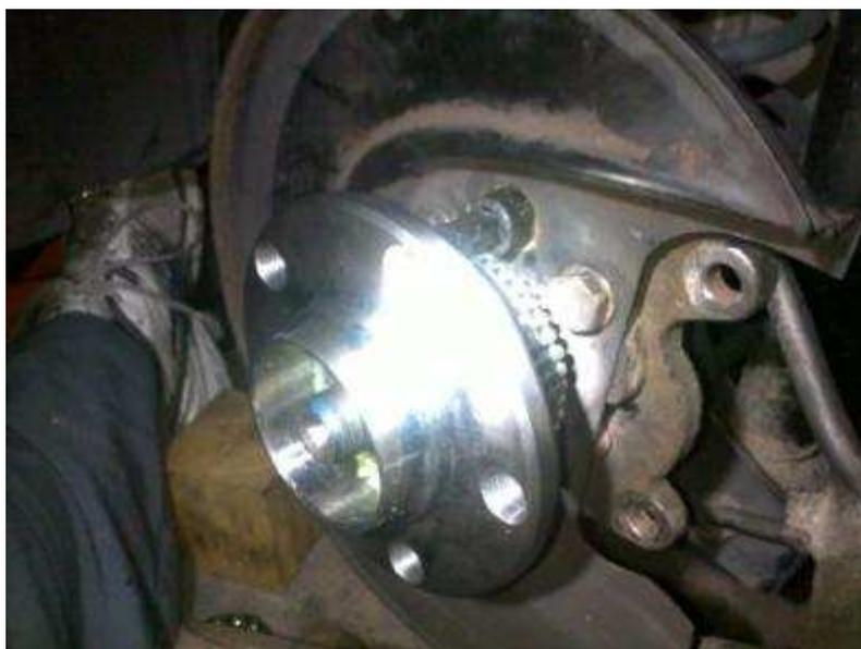
Ne reste plus qu'à remonter l'étrier et le disque (couple de serrage pour les vis de l'étrier : 80Nm), puis à serrer l'écrou dodécagonal à un couple de 175Nm.
